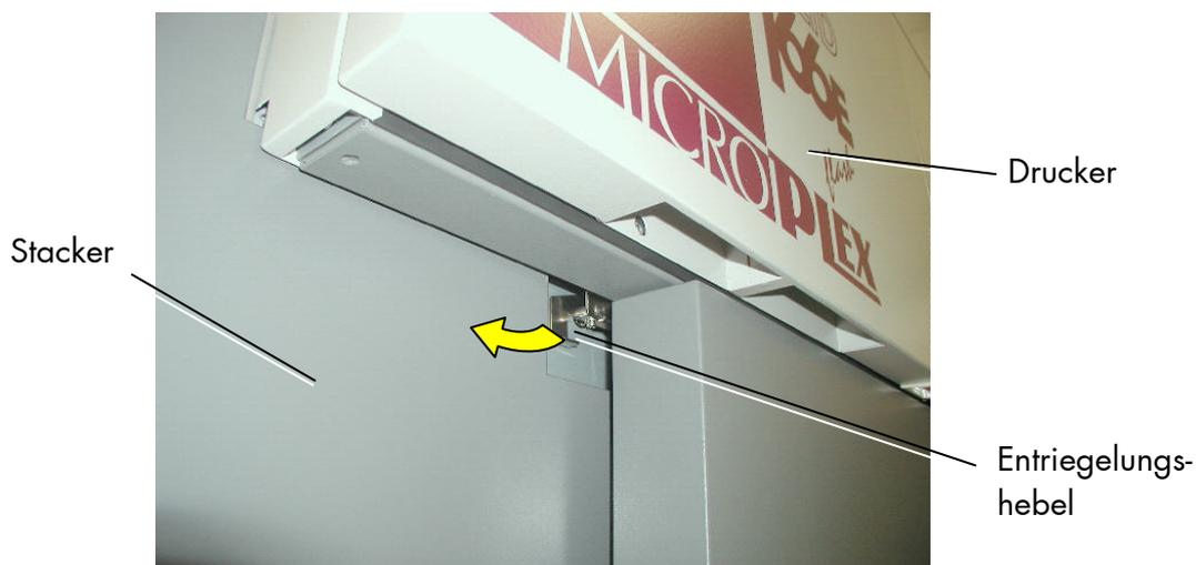
Abb. 3.2.8.d Entriegelungshebel des Stackers betätigen
