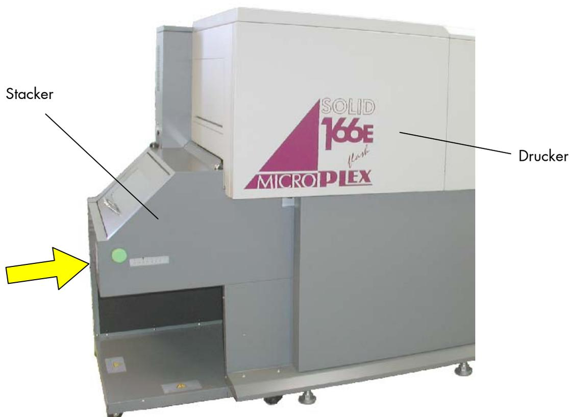
Abb. 3.2.2.e Den Stacker in den unteren Bereich des Druckers bewegen
